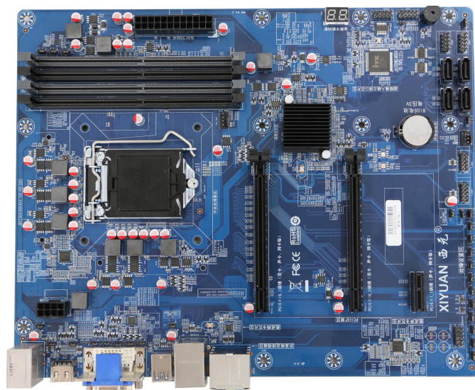
图 8 西元快速设置故障的计算机主板
