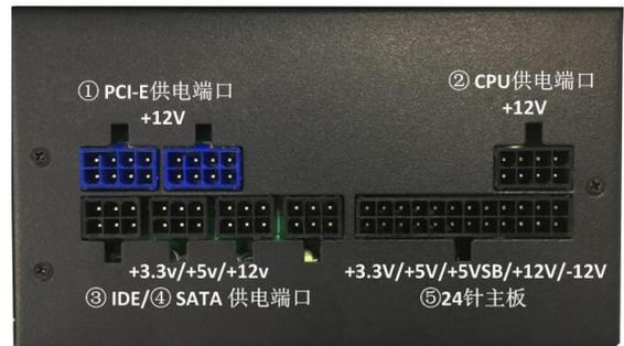
图 11 开关电源端口
