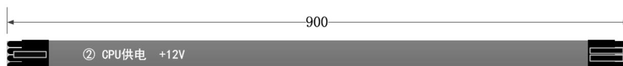
图12 CPU供电线
