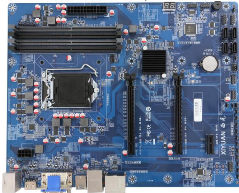
图 7 西元快速设置故障的计算机主板
